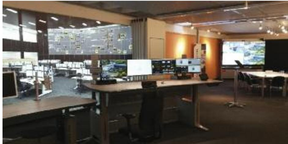
komplett rahmenlosen LCD-Displays (Barco Uni-See) wurden speziell für 24/7-Anwendungen im Kontrollraum entwickelt. „Mit nur einer Maus und Tastatur können wir von Wien aus verschiedenste Systeme unserer Kunden bedienen und testen (Barco OpSpace). Wir optimieren die Abläufe, um Ausfälle bereits vorab auszuschließen“, erläutert Markus Miksch.
