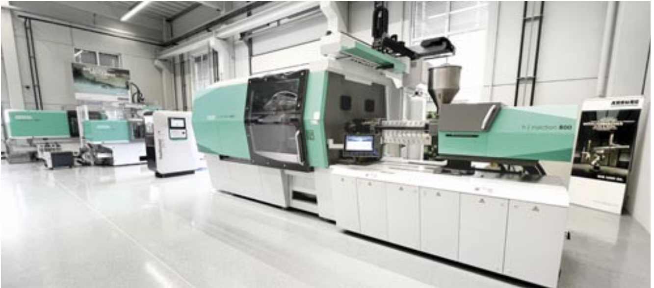
Im Arburg Technology Center (ATC) stehen Allrounder-Spritzgießmaschinen für praxisnahe Tests und Werkzeugabmusterungen bereit.
